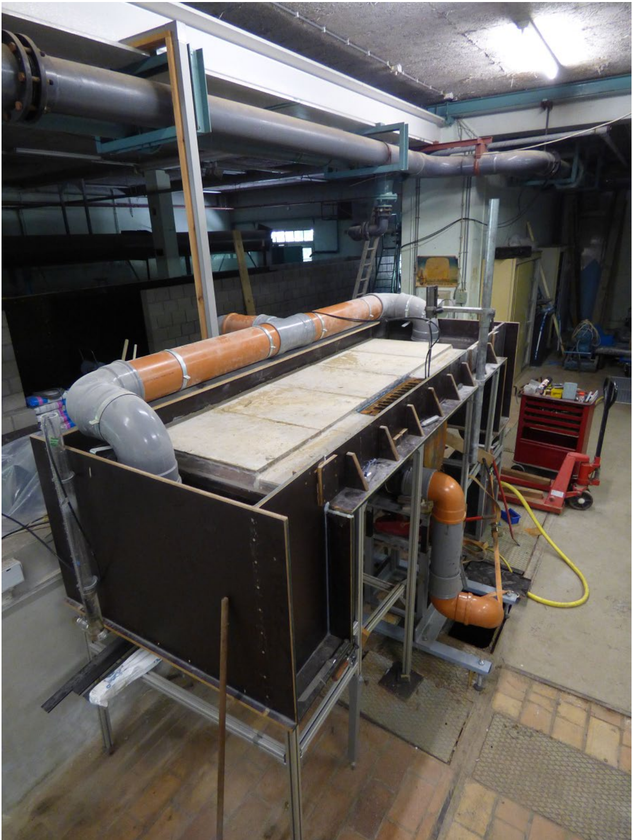
Photo 2 – Vue du dessus et du côté de la configuration (avaloir en fonte).
