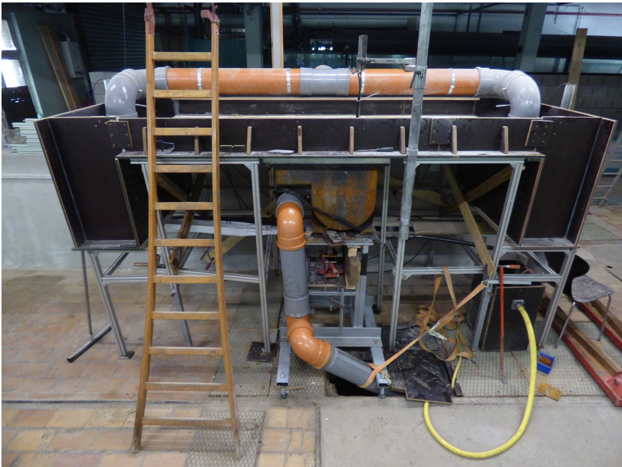
Foto 1 – Vooraanzicht van de proefopstelling (gietijzeren kolk).
